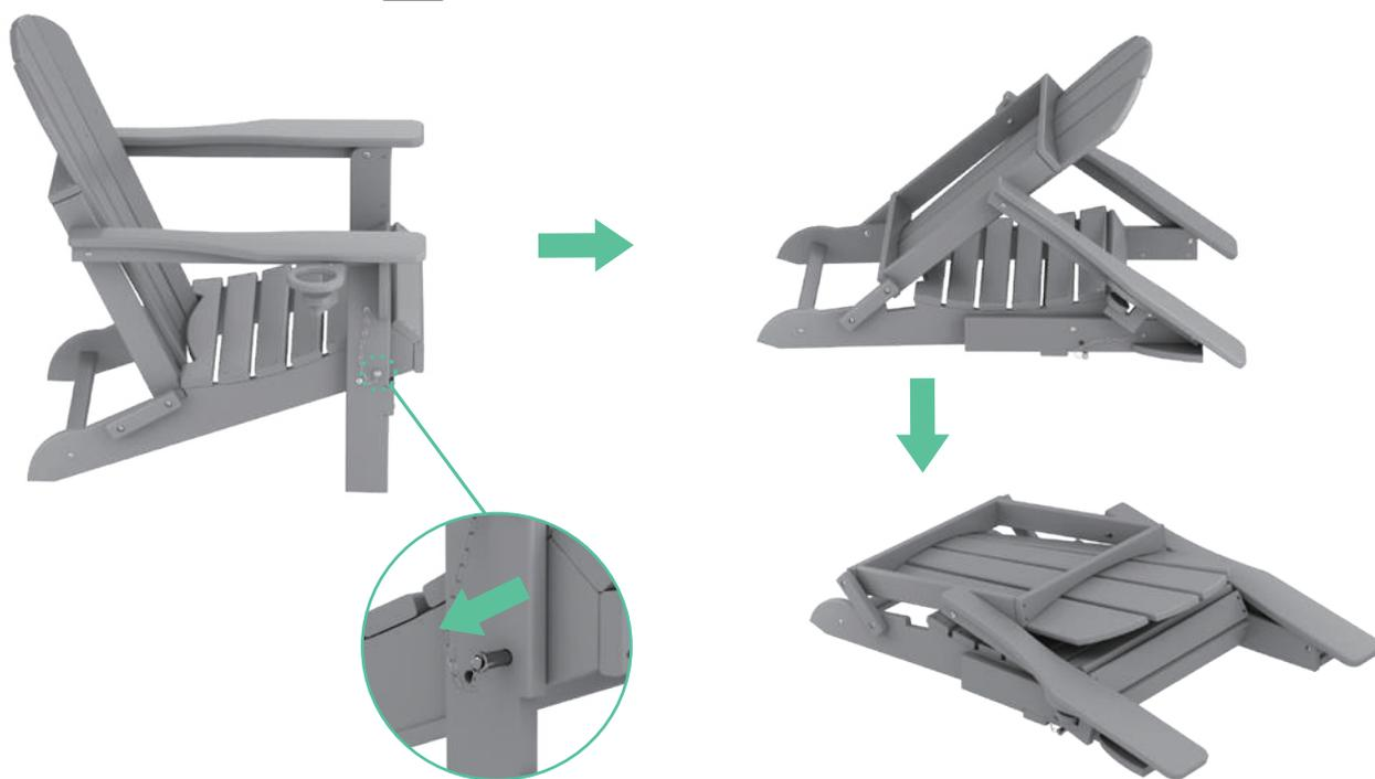
本体側面のロックピンを抜き、背もたれを引き上げるように前に倒します。※指など挟まない様ご注意ください。
